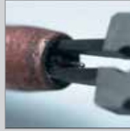
oczyszczanie wewnętrznej i zewnętrznej powierzchni dyszy
