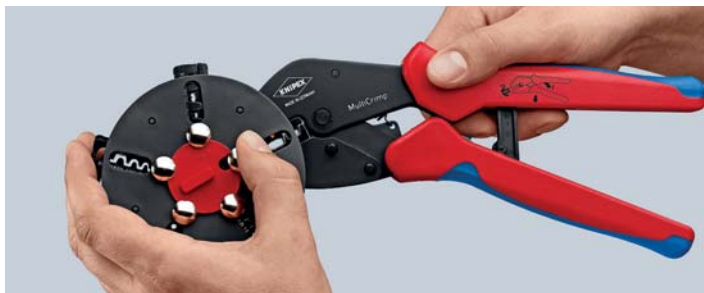
Wymiana matrycy do zagniatania: odblokować matrycę w magazynku, chwycić szczękami i wyjąć z magazynka
