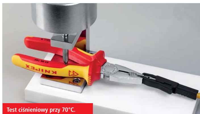
Testowanie przyczepności izolacji rękojeści z certyfikatem VDE przy 500 N w 70° C.
