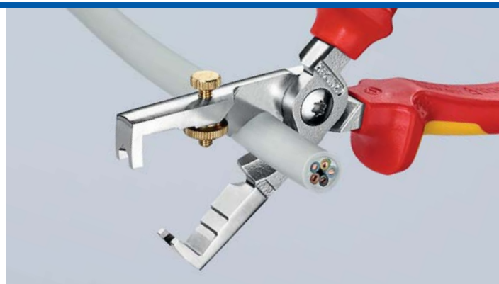
Precyzyjnie szlifowane i hartowane indukcyjnie ostrza nożyc umożliwiają cięcie kabli miedzianych i aluminiowych do \varnothing 15 mm (5 x 2,5 mm 2 ) bez deformowania krawędzi
