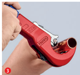
3 Przetnij rurę obracając narzędzie, a następnie wyreguluj za pomocą ergonomicznego niebieskiego pokrętła ...
