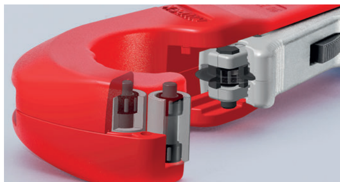
Krążek tnący i cztery roleki prowadzące pracują praktycznie bez tarcia podczas cięcia dzięki wysokiej jakości łożyskom igiełkowym - wyjątkowo łatwe cięcie rur ze stali nierdzewnej
