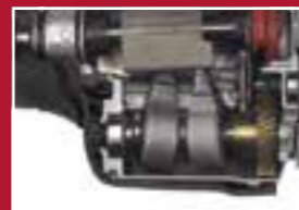
Mechanizm przeciwwagi zapewnia małe drgania - 12,5 m/s 2
